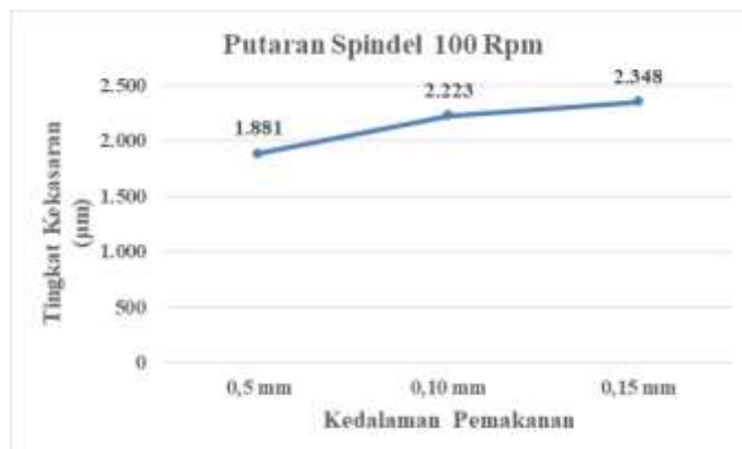
Gambar 3 Grafik tingkat kekasaran permukaan dengan kecepatan putaran spindel 100 rpm
