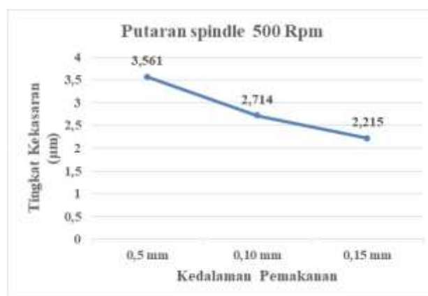
Gambar 5 Grafik tingkat kekasaran permukaan dengan kecepatan putaran spindle 500 rpm
