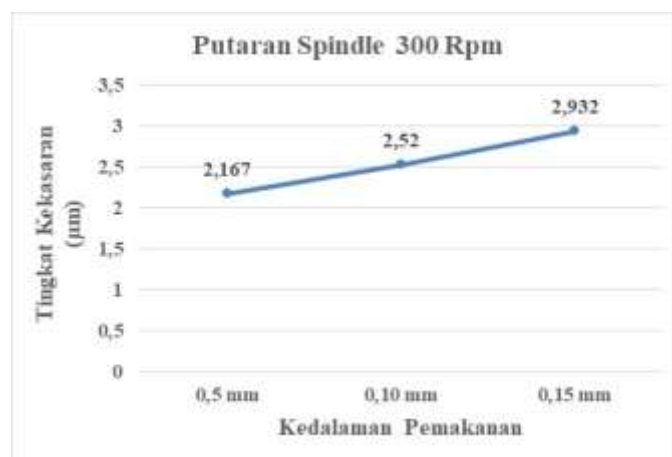
Gambar 4 Grafik tingkat kekasaran permukaan dengan kecepatan putaran spindel 300 rpm
