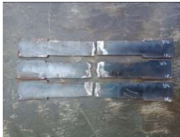
Gambar 3. Hasil pengujian Speciment media pendingin Air 15°C
