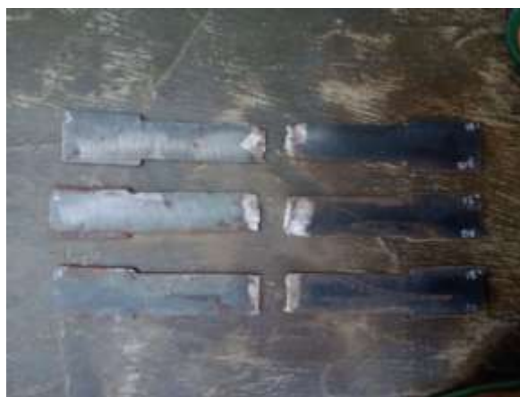
Gambar 4. Hasil pengujian Speciment pengujian tarik media Oli 15°C
