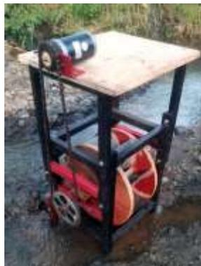
Gambar 1. *Prototype* Pembangkit Listrik Tenaga *Microhydro* (PLTMH)
