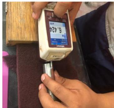
. Gambar 6. Pengukuran kekasaran permukaan hasil pemotongan pahat LA A485-1
