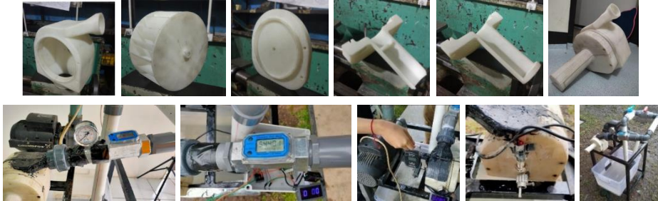
Gambar 2. Konstruksi fisik dan persiapan pengujian turbin crossflow eksisting
