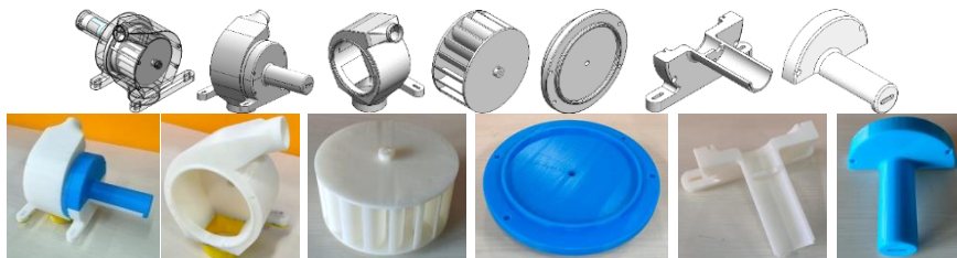
Gambar 4. Realisasi rancangan modifikasi alat PLTPH cross flow dengan 3D print
