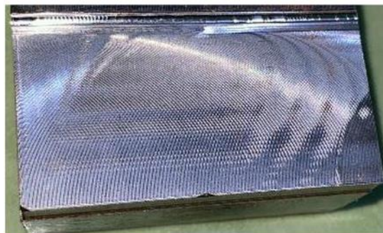
Gambar 5. Visual hasil pengujian kekasaran rata-rata 2,3 \mu\text{m} untuk depth of cut 1 mm
