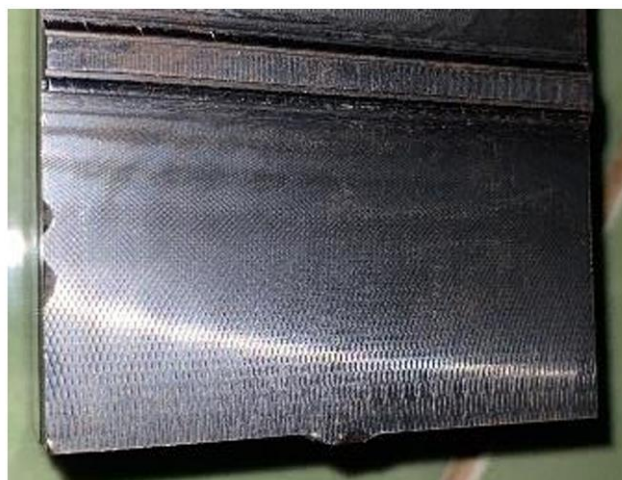
Gambar 7. Visual hasil pengujian kekasaran 1,64 \mu\text{m} untuk depth of cut 1 mm
