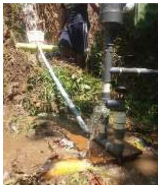
Gambar 4 Prototype pompa hidram
