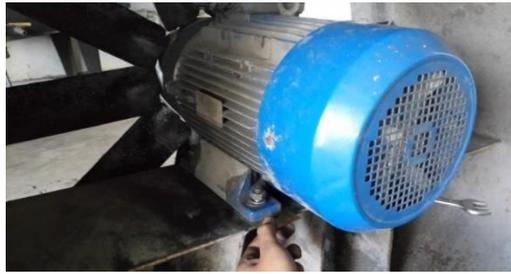
Gambar 12. Proses pemasangan im 0,25 mm pada pondasi motor
