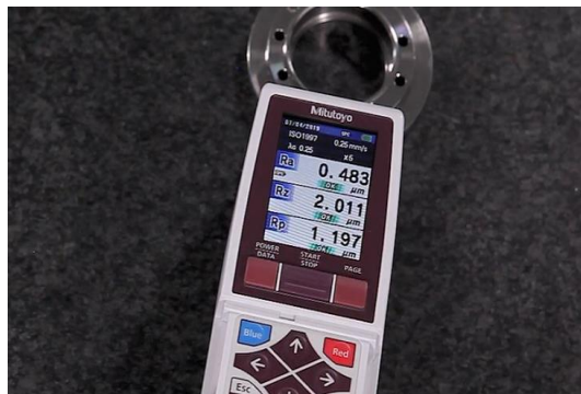
Gambar 6. Hasil pengukuran kehalusan menggunakan Roughness tester metode pembakaran double firing
