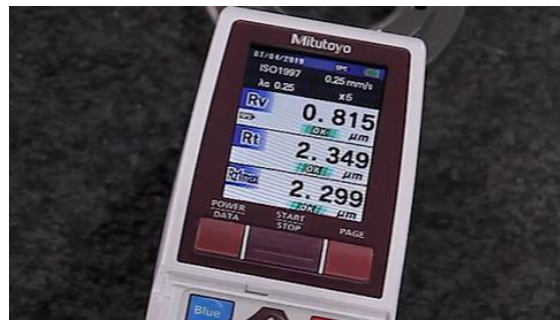
Gambar 4. hasil pengukuran kehalusan menggunakan Roughness tester metode pembakaran single firing
