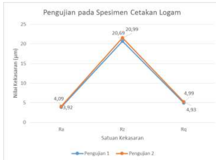
Gambar 4. Diagram hasil pengujian kekasaran logam media cetakan logam
