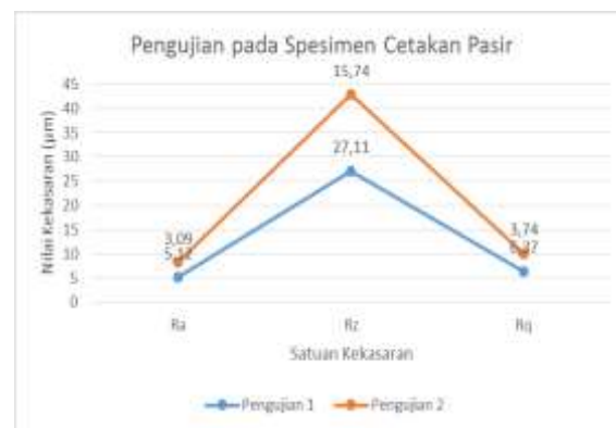
Gambar2. Diagram grafik hasil pengujian kekasaran logam media cetakan pasir
