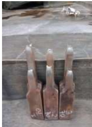
Gambar 4 Hasil pengujian pada spesimen yang dilas menggunakan elektroda E7018
