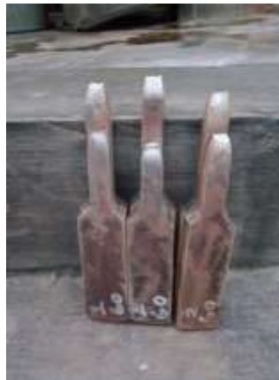
Gambar 3 Hasil pengujian pada spesimen yang dilas menggunakan elektroda E6013
