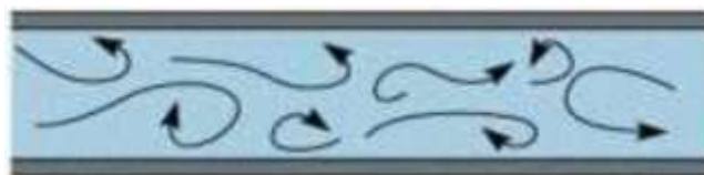
Gambar 2. Pola garis arus aliran turbulen
