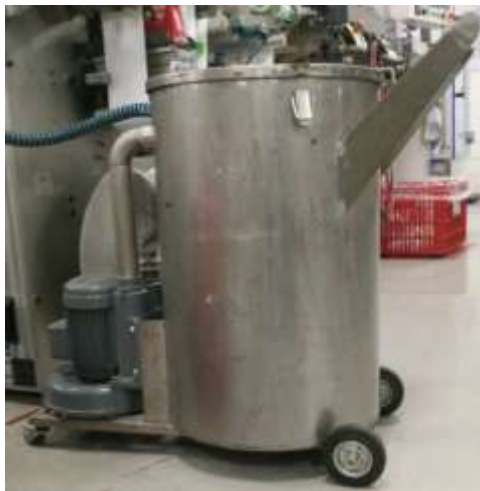
Gambar 9. Trimming Dengan Sistem Motor Vacuum
