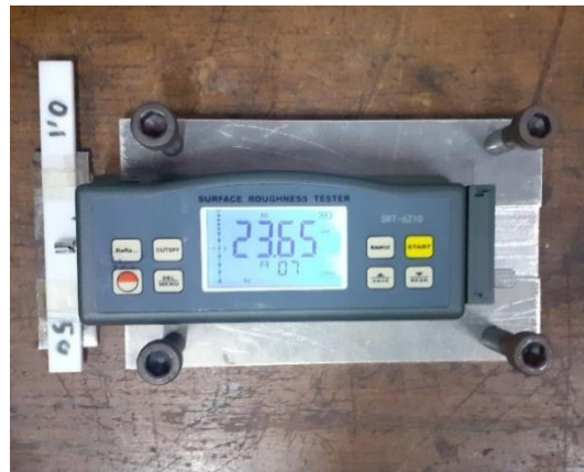
Gambar 3. Alat Uji Kekasaran ( Surface Tester )
