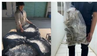
**Gambar 8.** Perbandingan volume *styrofoam* sebelum dan setelah proses termal-ekstrusi
