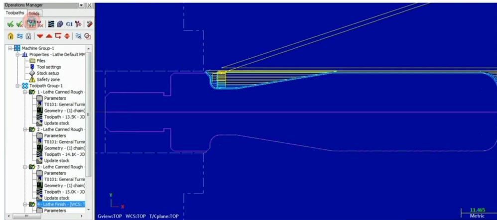
Gambar 3. Jalur pergerakan pahat pada proses pemakanan benda kerja *fixed handle*
