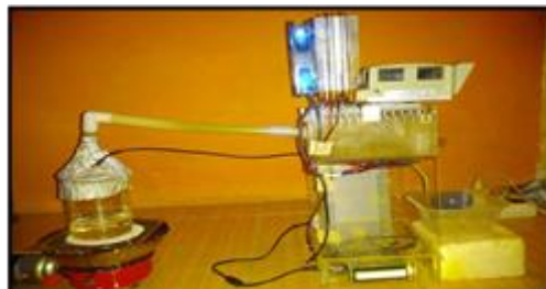
Gambar 6. Rancangan Alat Destilasi Air Laut
