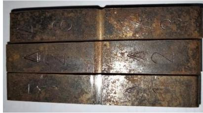
Gambar 2. Spesimen Baja JIS SUP 9
