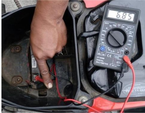
Gambar 4 Baterai kekurangan tegangan
