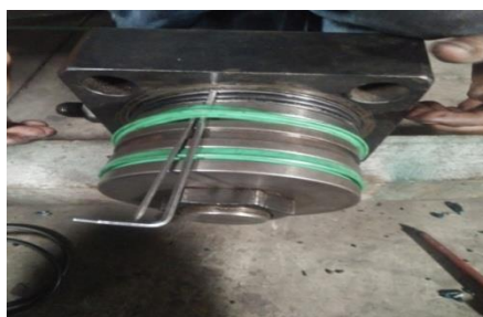
Gambar 14. Pemasangan seal baru
