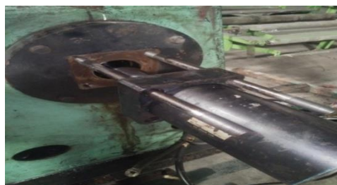
Gambar 10. Proses pelepasan silinder hidrolis pada bodi mesin uncoiler
