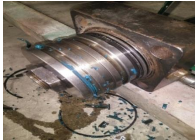
Gambar 11. Piston hidrolis seal rusak
