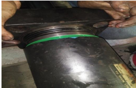
Gambar 15. Pemasangan piston ke barrel
