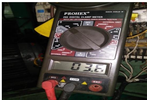
Gambar 17. Hasil pengukuran ampere motor
