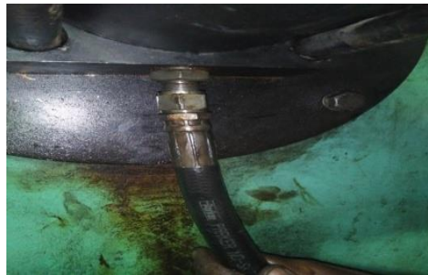
Gambar 8. Proses pelepasan selang hidrolis
