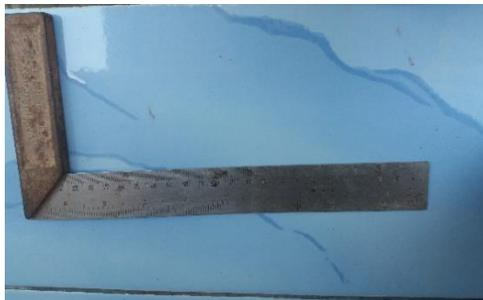
Gambar 5. penggaris untuk mengukur spesimen
