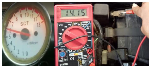
Gambar 15. Pengukuran kedua dan ketiga pada 3000 rpm dan percobaan 1-3 pada 6000 rpm
