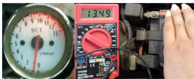
Gambar 13. Pengukuran ketiga pada 1000 rpm
