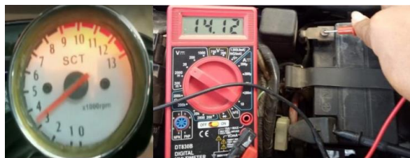
Gambar 14. Pengukuran pertama pada 3000 rpm
