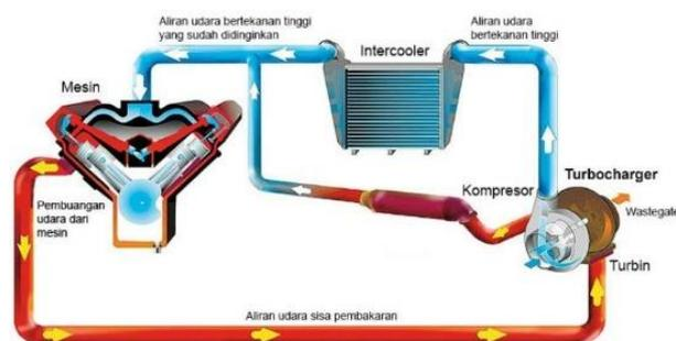
Gambar 2 Skema *turbocharger* pada mesin diesel
